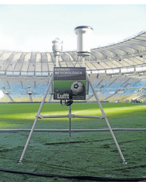
Über die Kompaktwetterstationen der Firma Lufft ist es möglich, Wetterdaten wie Temperatur, relative Feuchte oder Luftdruck zu erfassen. Damit die Spieler wissen, welche Stellen sie aufziehen, damit das Runde ins Eckige geht.
